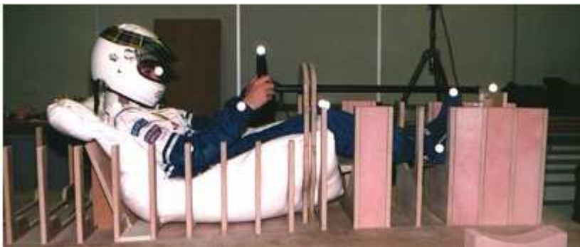
Figura 27: Mockup físico de simulação de postura (RAMSIS)
