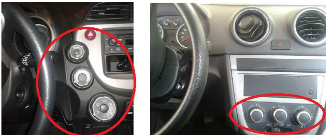
Figura 36: Dois exemplos de layouts de controles. O layout da esquerda atende melhor às recomendações técnicas da SAE
